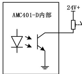
从输出开关量的原理示意图可知，输出开关量驱动的外部电路要满足两个要点：
